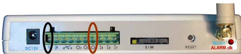
Figur 1. Relæboksens ledninger skal forbindes til port 1 og 7 som vist på tegningen.
